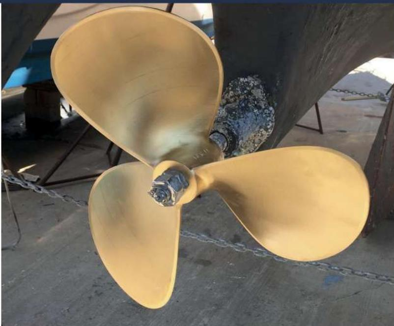
Las hélices convierten la energía de rotación generada por el motor en el empuje necesario para el desplazamiento de un barco.
